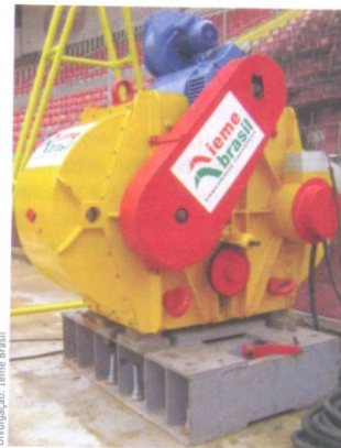
Vibrodina: equipamento de tecnologia italiana simula a dinâmica das torcidas para a análise estrutural do estádio
