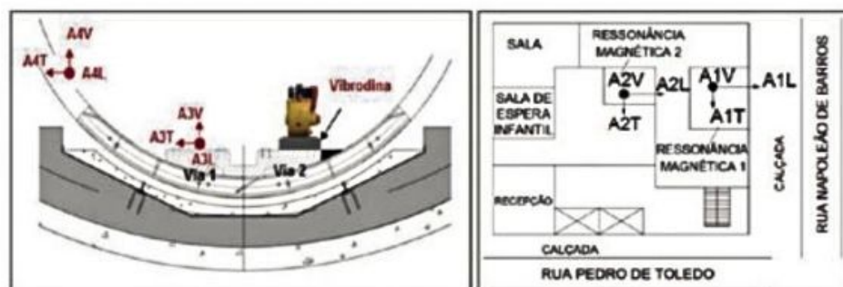
Figura 5 - Seção do túnel e planta do segundo subsolo do edifício da ressonância com as instrumentações realizadas no edifício de ressonância magnética do Hospital São Paulo
