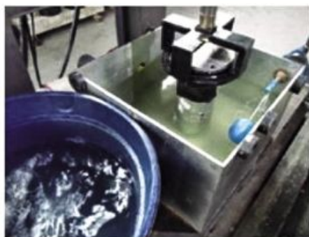
Figura 11 - Foto do ensaio de Fadiga do amortecedor
